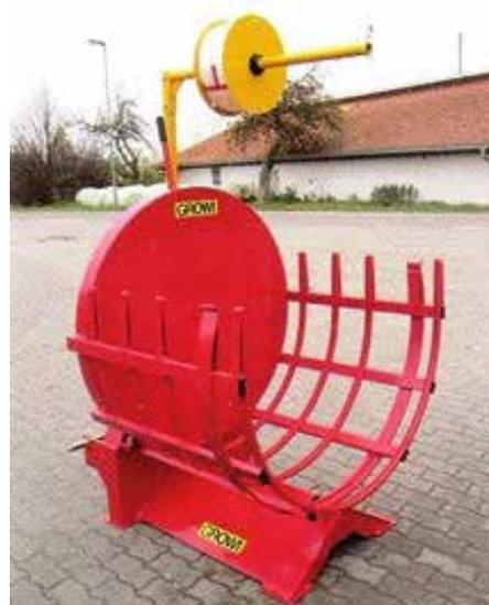
1 - Meter langen Scheitholzbündeln mit einem Raummeter, welche dann zum Trocknen und transportieren bequem mit Kran, Frontlader oder Palettengabel bewegt werden können. Gebunden wird mit Gewebebändern.
