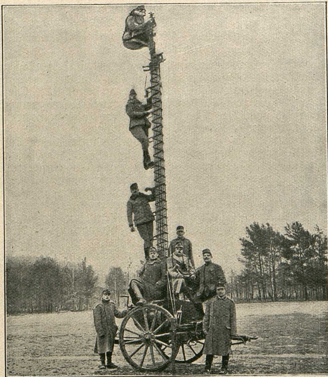
Photopresse Kantowösky, Budapest. Fahrbare und zusammenlegbare österreichisch-ungarische Beobachtungsstelle mit Telephon.
