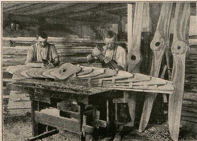
In einer Propellerfabrik: Anfertigung des Propellers aus einzelnen Holzblättern.
