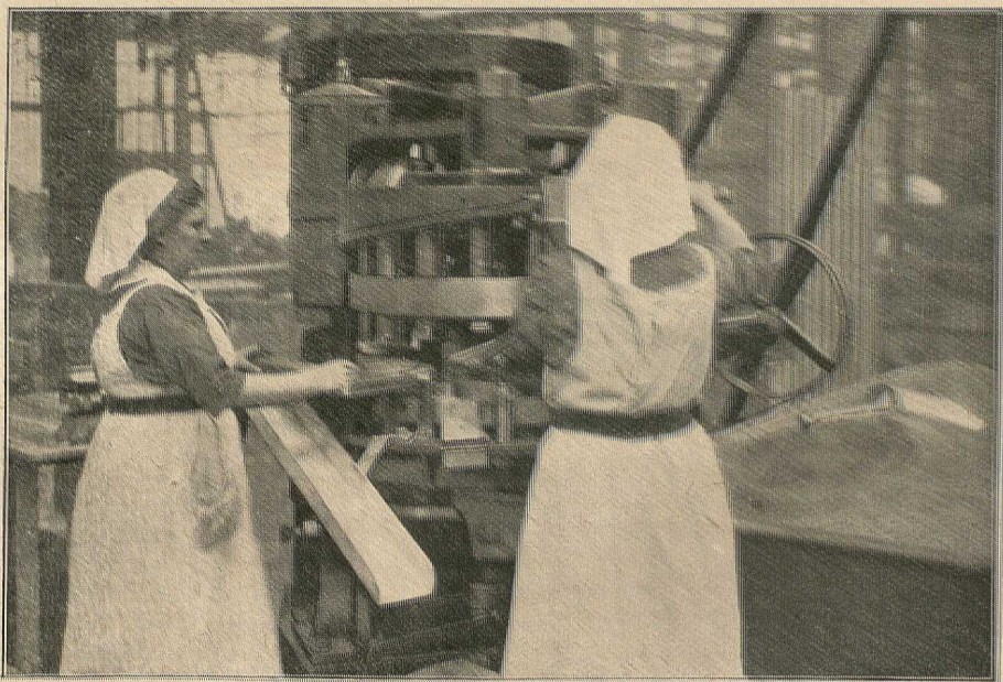
In der Maschine zur Herstellung von Gemüsemehlwürfeln: Das Gemüsemehl wird in die Maschine geschüttet und kommt als Würfel wieder heraus.
