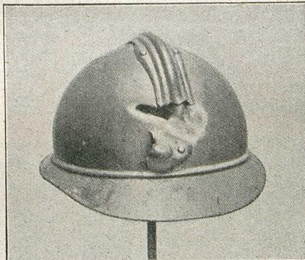
Fig. 4. Helm in Steinhöhe von einer Gewehrkugel getroffen.
