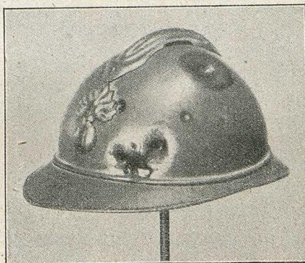
Fig. 5. Von fünf Schrapnellsplintern verletzter Helm, der nur an einer Stelle durchschlagen wurde.
