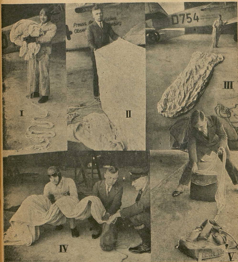
Samt den Schnüren ist der Fallschirm 16 Meter lang (I) — Gutes Falten ist wichtig (II) — Vor dem Einpacken (III) wird zickzackförmig gefaltet (IV) — Gurt und Tragschnüre bleiben außerhalb des Sackes, denn der Flieger muß sie ja anlegen (V)
