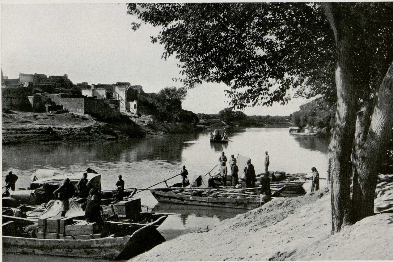
Kriegstransport deutscher und türkischer Soldaten auf dem Euphrat bei Der es Sor. Die prahmartigen Schiffsformen stellten ein geeignetes Transportmittel auf dem Euphrat und Tigris mit ihren zahllosen Untiefen und Stromschnellen dar.
