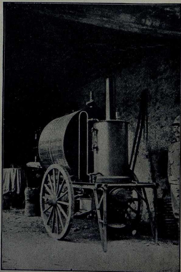
Eine Entlausungsmaschine für die Kleider der Truppen in Russisch-Polen.
