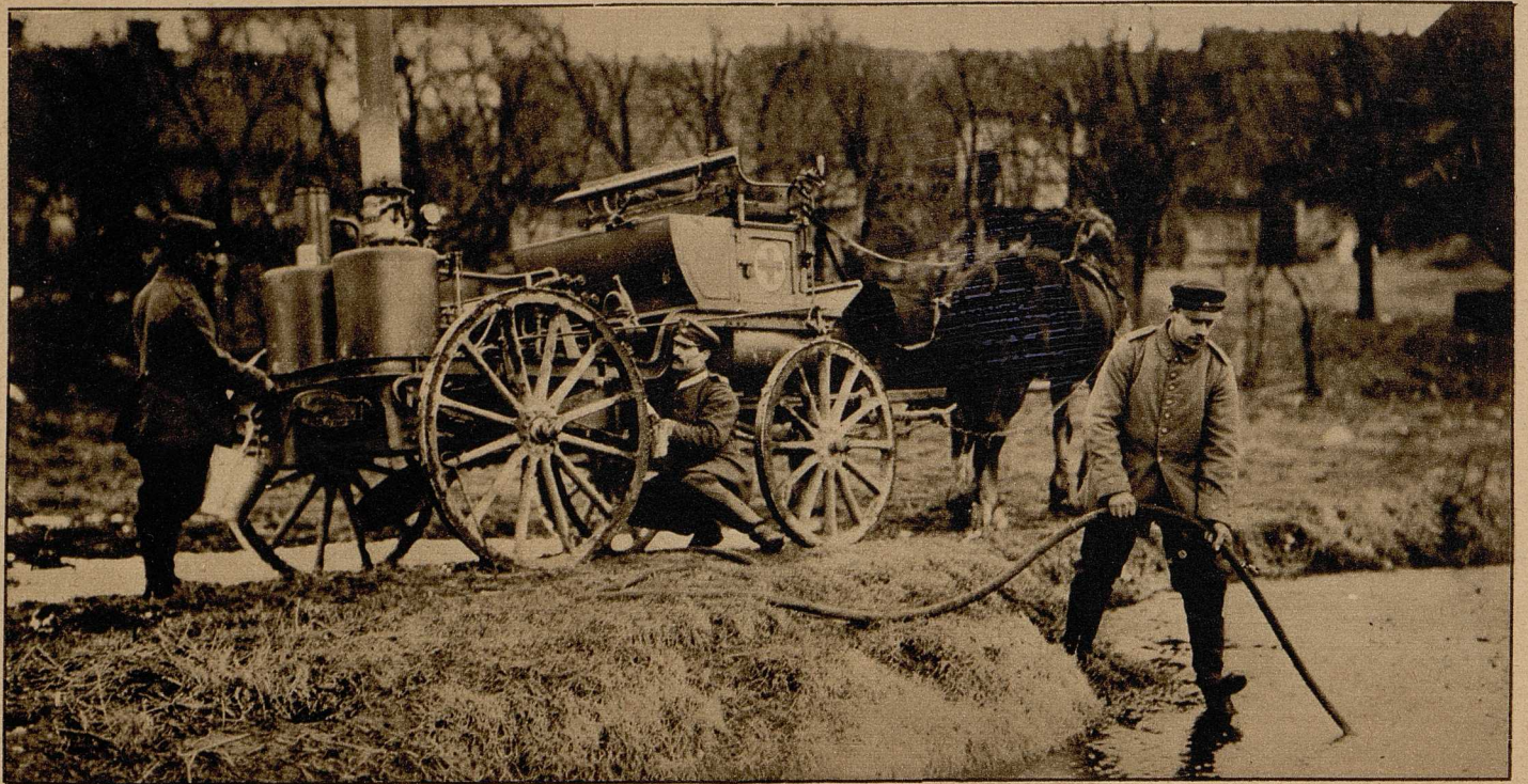
Verforgung unserer Soldaten mit keimfreiem Trinkwasser: Einer der im Osten verwendeten fahrbaren Destillierapparate. Das Wasser kann, wie das Bild zeigt, aus jedem Teich oder sonstigem Gewässer entnommen werden. (Photothek.)
