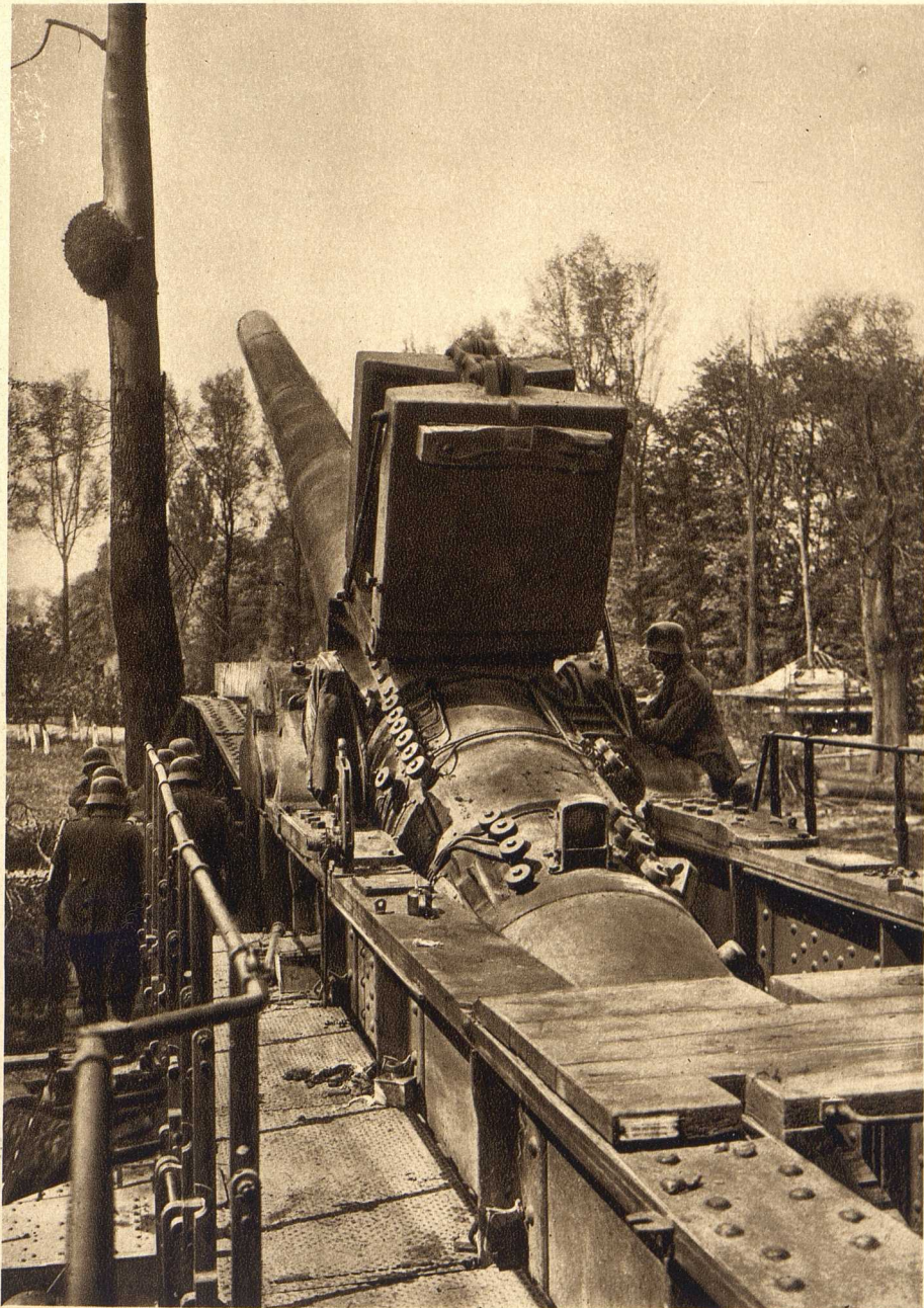
38 cm Schnelladekanone, Eisenbahnbettungsgeschütz. Ein „langer Max“, bei dem die Erhöhung genommen wird. Mit solchen Geschützen wurden Dünkirchen und Verdun beschossen.
